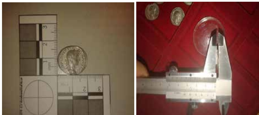
Fig. 19. Determinación de módulo y espesor mediante testigo métrico milimetrado bidimensional y calibre, respectivamente. Fuente: Autor
