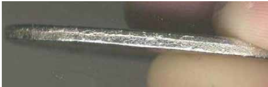
Fig 9. Observación de la costura presente alrededor de todo el canto. Fuente: Muñiz García, 2014, p. 4.
