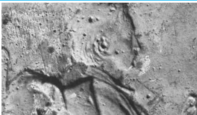
Fig. 14. Observación aumentada del reverso de una falsificación por electrotipo, en donde se observan los nódulos característicos. Fuente: http://cool.conservation-us.org/coolaic/jaic/articles/jaic23-02-002.html
